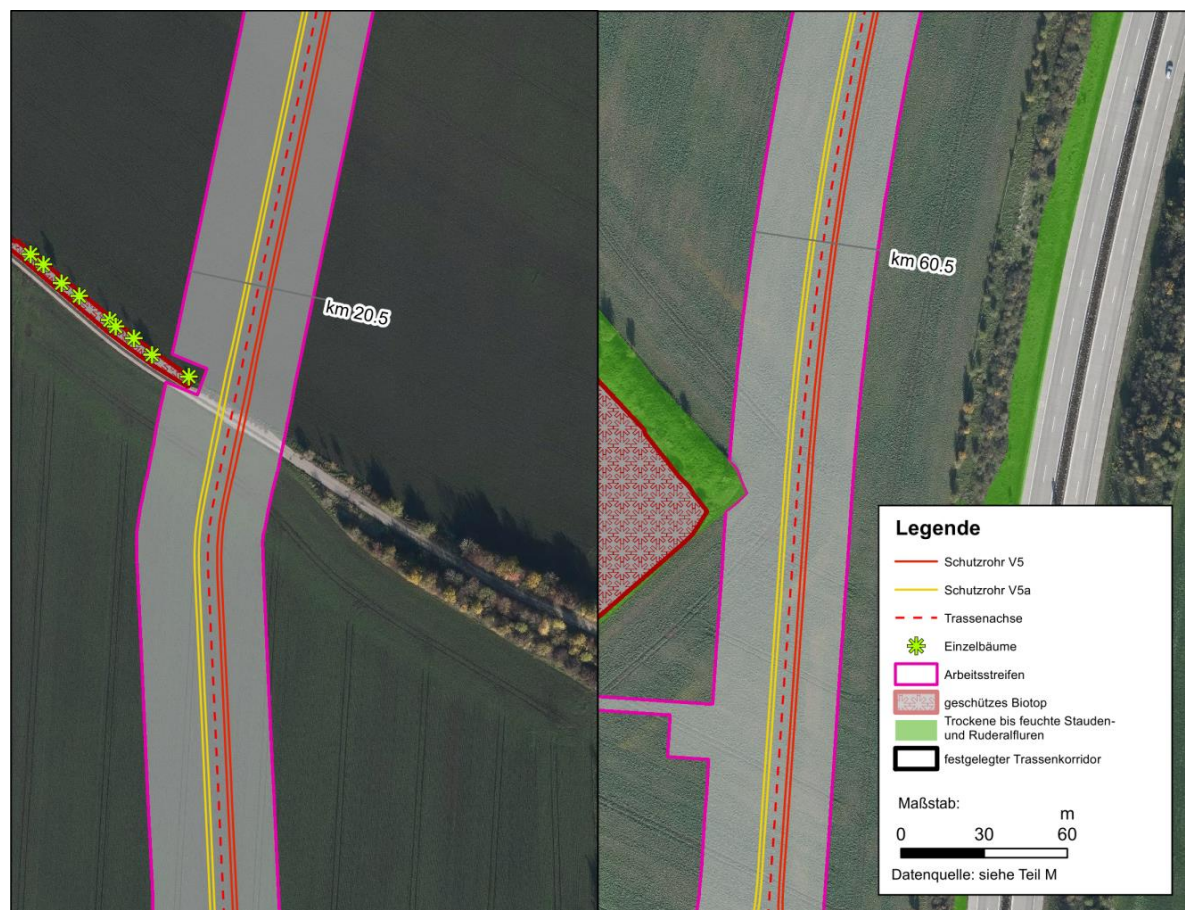
Abbildung 1: Beispiele für individuelle Anpassungen des Arbeitsstreifens an Umweltrestriktionen bei TKM km 20,5 und TKM km 60,5
